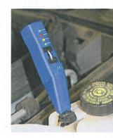
der Wasseranteil weniger als ein Prozent, bei Rot und mehr als drei Prozent Wasseranteil ist ein Wechsel dringend nötig. Der Check-Pen kostet 38,99 Euro. .....
