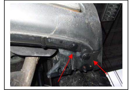
3 Clipse am Stoßfänger unten rechts
