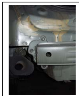
Demontagepunkte 6xM8 Stoßfängergrundträger
