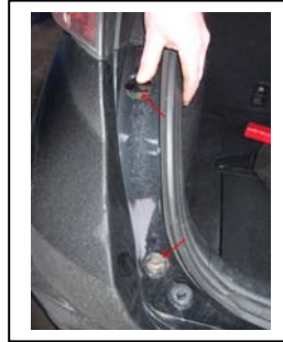
Befestigung Stoßfänger Links 2xM6
