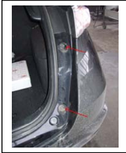
Befestigung Stoßfänger Rechts 2xM6
