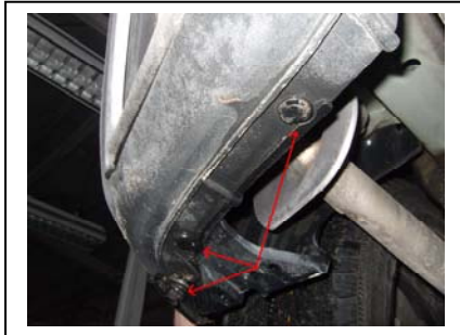
3 Clipse am Stoßfänger unten links
