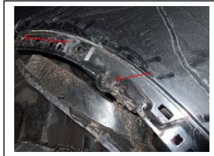
1 Clips, 1 Schraube an der Radhausverkleidung li+re
