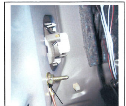
Masseverbindung bei linker Heckleuchte nutzbar
