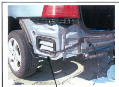
Durchführung Kabelstrang durch linkes Lüftungsgitter
