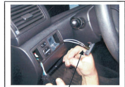
Kontrollleuchte im Sichtbereich montieren und anschließen
