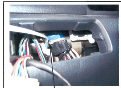
mitgeliefertes Relais auf den Sockel stecken und Kabel ev. mit Kabelbinder befestigen
