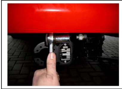
Kukelkopfaufnahme und Steckdosenplatte montieren
