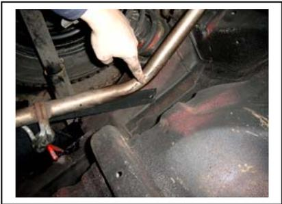
Auspuffrohr mit Zwinne zur Seite biegen, 11 mm Loch bohren
