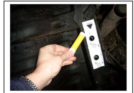
Mit einem Klebestift die Schablone am Fahrzeugboden befestigen
