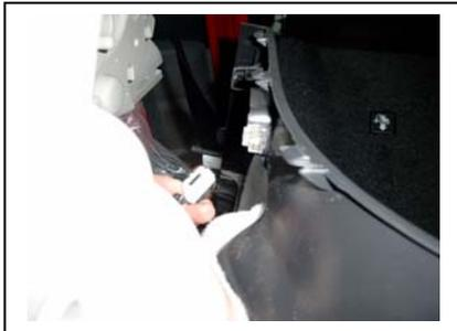
Bei der linken Verkleidung den Steckkontakt der Beleuchtung lösen
