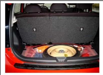
Kofferraumabdeckung entfernen, Notrad und Zubehör entfernen
