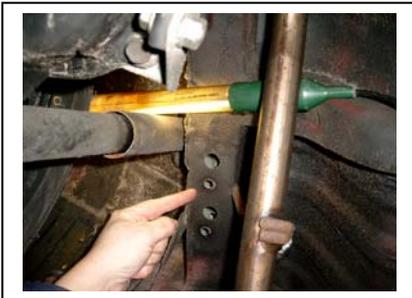
Den Träger von unten nach oben 11 mm durchbohren
