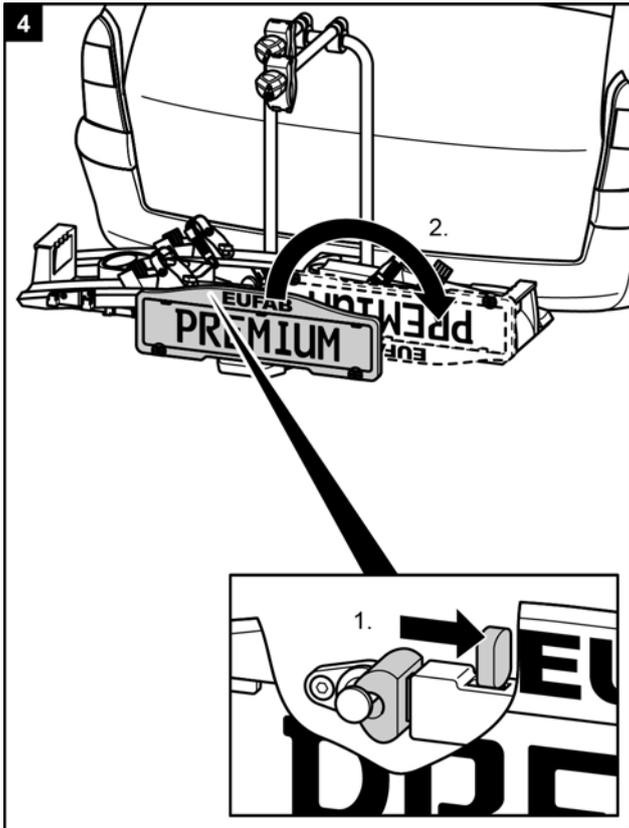
Beim Entfernen des Fahrradträgers gehen Sie anschließend in umgekehrter Reihenfolge der Montage vor.
