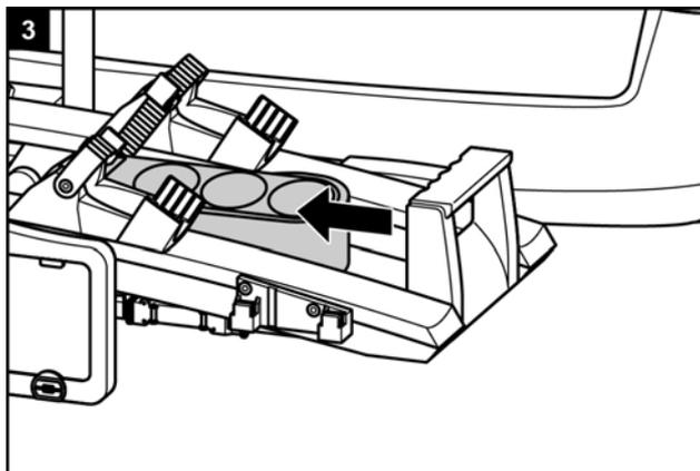
Lösen Sie zuerst den Verriegelungsbolzen hinter dem Kennzeichenhalter.
