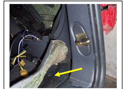
Kabeldurchführung rechts und links ohne Demontage der Seitenverkleidung
